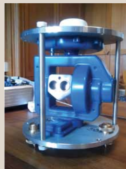
De Autodif magnetometer, met het nieuwe systeem voor het bepalen van het geografische noorden en de beschermkappen.
